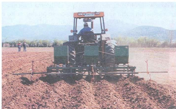
Figura 3.11. Conformación de los camellones con un cultivador abonador de enganche integral al tractor.
