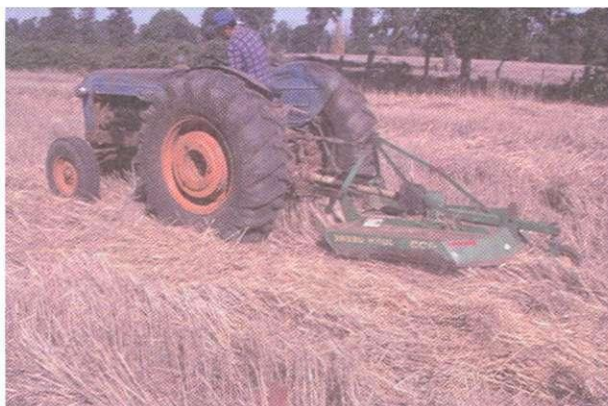
Foto 3.6. Picado de rastrojos con desmalezadora rotativa.
