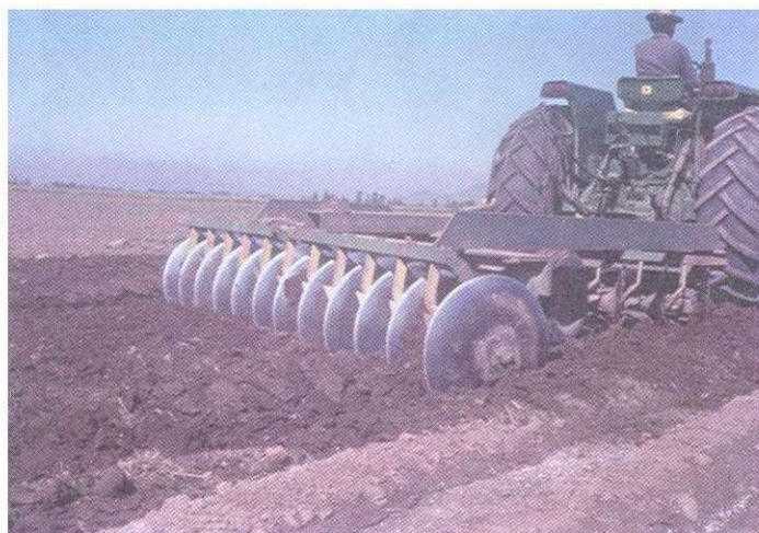
Foto 3. 8. Rastra de disco para lograr el adecuado “mullimiento” del suelo.
