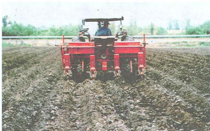
Foto 3.12. Siembra de garbanzo con sembradora neumática sobre los camellones.
